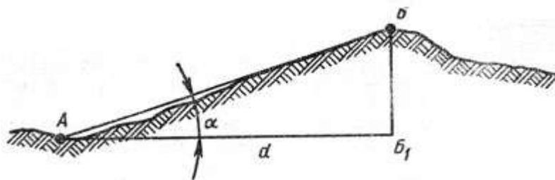
Решение. По горизонталям (отметкам) карты определяем абсолютные высоты точек А и Б. Пусть они соответственно равны 110 и 230 м. Расстояние между ними ( $AB_1 = d$ ), измеренное по карте, оказалось равным 600 м.
