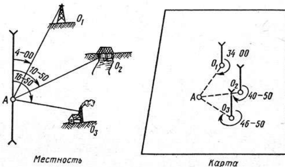
Определение координат привязываемой точки засечкой по обратным дирекционным углам заключается в нахождении на местности дирекционных углов с привязываемой точки А на два-три местных предмета (точки O1 O2, O3), имеющих на карте, с последующим построением измененных на 30-00 дирекционных углов на карте при соответствующих точках. Пересечение направлений измененных дирекционных углов на карте даст нам координаты привязываемой точки.
