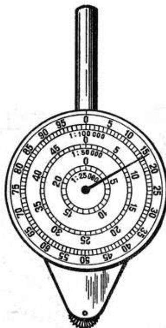
Прибор представляет собой круглую коробочку с держателем. В центре прибора находится циферблат со стрелкой, внизу имеется колесико, при помощи которого обводится маршрут. Колесико соединено системой передач со стрелкой на циферблате, которая ведет отсчет величины пройденного расстояния по карте.
