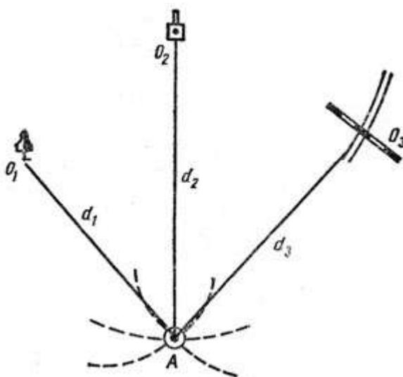
Определив расстояния до этих точек, наносят на карту по известным координатам контурные точки и прочерчивают с них циркулем дуги радиусами, равными измеренным расстояниям в масштабе карты. В пересечении дуг получают привязываемую точку.
