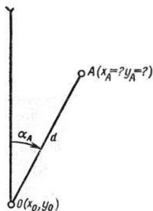
Сущность этого способа заключается в измерении на местности полярных координат ( $\alpha_A$ ,  $d$ ) привязываемой точки и в определении по ним прямоугольных координат ( $x_A$ ,  $y_A$ ) этой точки.
