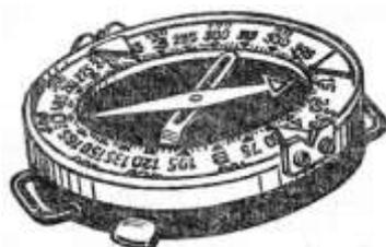
Сверху на коробке компаса укреплена крышка со стеклом, снабженная простейшим приспособлением для визирования: мушкой и прорезью. На внутренней стенке крышки, против мушки и прорези, укреплены указатели для отсчетов по шкале лимба. Крышка компаса вращается, поэтому визирное приспособление может быть установлено по шкале в любом заданном направлении.
