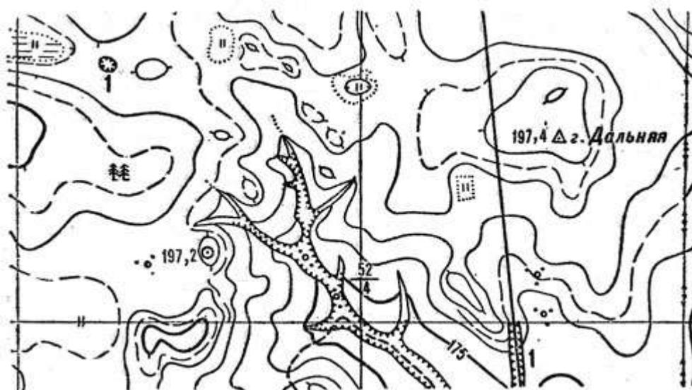
Горизонтали, соответствующие основному сечению рельефа, называются **основными** и обозначаются сплошными линиями. Для подробного изображения рельефа проводят **половинные** (через половину высоты сечения) и **вспомогательные** (примерно через четверть высоты сечения) горизонтали в виде прерывистых линий.
