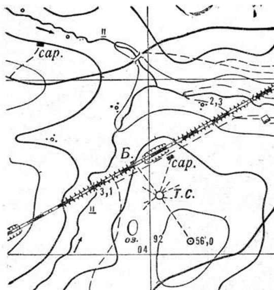
Для этого на местности измеряют расстояние от привязываемой точки до трех выбранных контурных точек. Затем на карте при помощи циркуля из каждой контурной точки радиусом, соответствующим измеренному расстоянию до данной точки, прочерчивают дуги и в пересечении их или в центре треугольника погрешности получают положение привязываемой точки.
