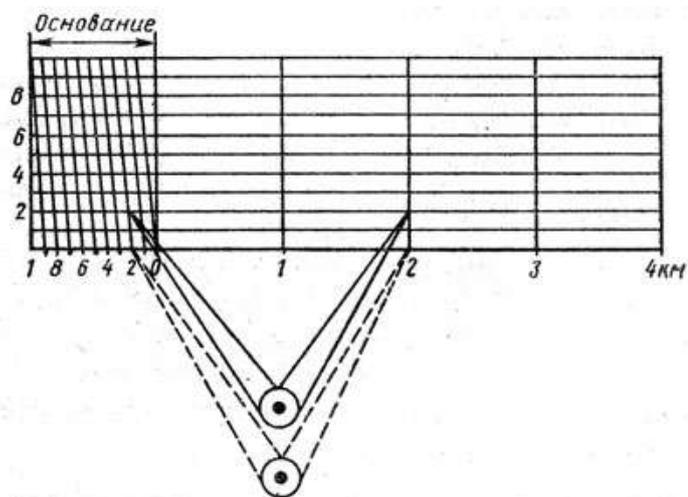
Каждая такая часть называется основанием масштаба. Крайнее левое основание в верхней и нижней частях поперечного масштаба делится на десять равных частей. Концы этих десятых долей основания соединяются между собой прямыми, отсекающими на горизонтальных линиях сотые доли основания.
