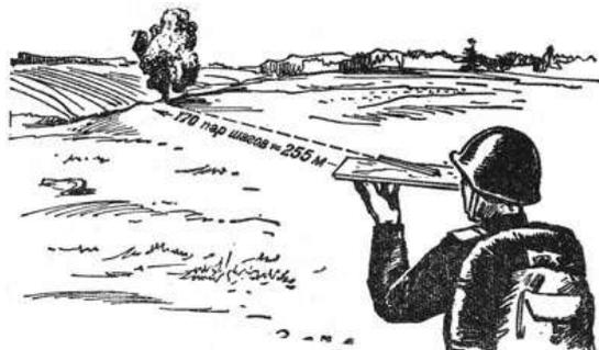
Для привязки этим способом ориентируют карту на определяемой точке и обратным визированием по контурной точке (местному предмету) при помощи визирной линейки прочерчивают направление. Затем измеряют расстояние до контурной точки (местного предмета), откладывают его на прочерченной прямой в масштабе карты и таким образом находят положение привязываемой точки.
