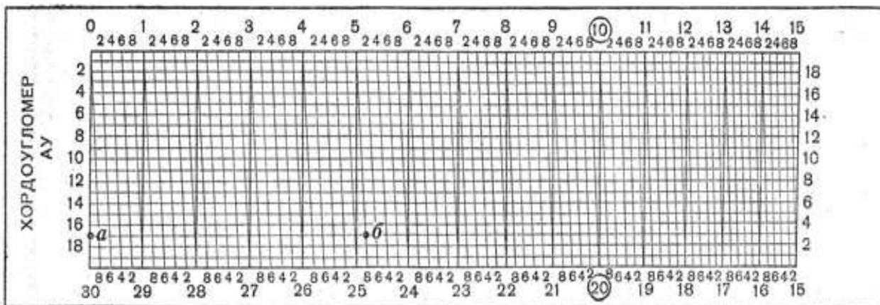
Способ измерения и построения углов по хордам основан на том, что каждому острому углу (до 15-00) соответствует определенной величины хорда окружности, проведенной из вершины угла.
