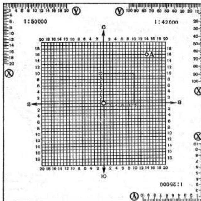
Рис. 7. Координатомер и пользование им для определения координат точки на карте
