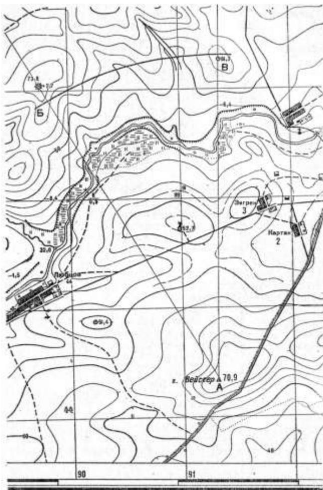
Из вершины измеряемого угла А при помощи циркуля проводят дугу радиусом, равным хорде угла 10-00 на хордоугломере. Циркулем берут величину хорды БВ измеряемого
