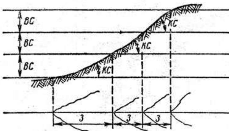
Высота основного сечения рельефа для определенного листа карты является величиной постоянной, она указывается на полях карты под линейным масштабом. Для топографических карт РФ высота основных сечений рельефа принята в 5 (10) 10 (20), 20 (40), 40 м соответственно для масштабов карт 1 : 25 000, 1 : 50 000, 1 : 100 000, 1 : 200 000.
