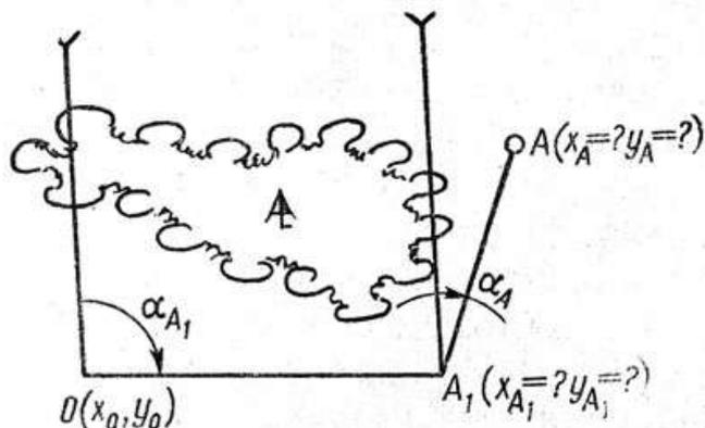
Для получения координат привязываемой точки А определяют координаты вспомогательной точки Л с которой видна контурная точка О, и от вспомогательной точки находят координаты привязываемой точки. Для определения координат вспомогательной и привязываемой точек применяют полярный способ. Следовательно, ход есть последовательное нахождение координат точек полярным способом.
