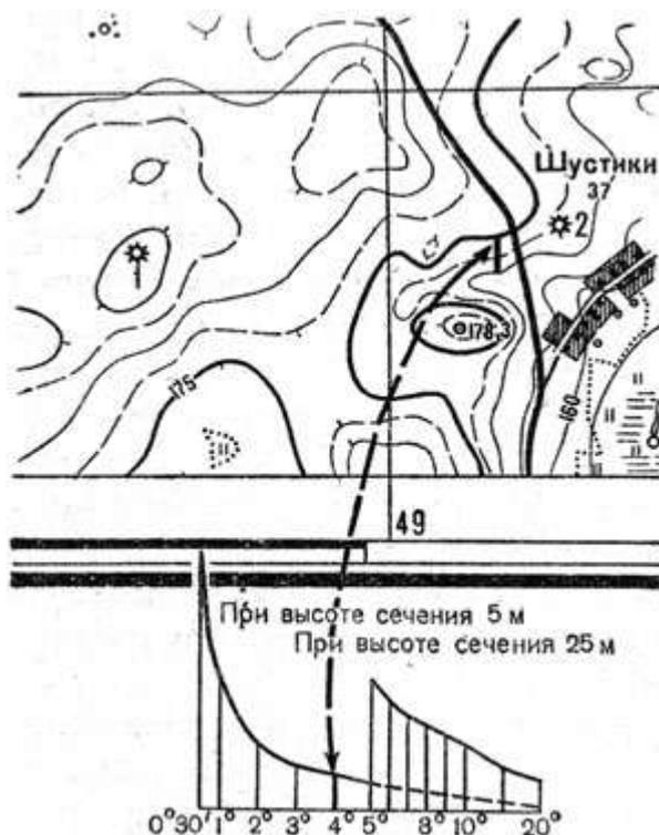
Этот способ заключается в том, что для нахождения крутизны ската на каком-либо участке дороги с помощью полоски бумаги или циркуля измеряют расстояние между горизонталями, проходящими через те точки, крутизна ската между которыми определяется. Отмеченное на полоске бумаги или же обозначенное раствором циркуля расстояние (на рис. 20 оно обозначено утолщенной полоской) переносят на шкалу заложений, как показано на рис. 20.
