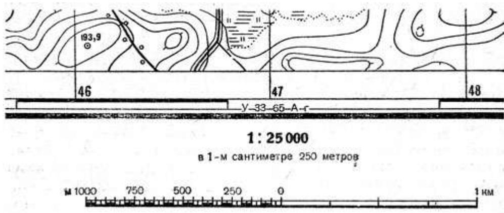
Чтобы определить по карте расстояние между местными предметами (точками местности) пользуясь численным масштабом, измеряют линейкой или циркулем расстояние между этими предметами (точками местности) в сантиметрах и умножают полученное число на величину масштаба. Например, по карте масштаба 1 : 25 000 расстояние между наблюдательными пунктами равно 5,5 см, а расстояние между этими пунктами на местности будет равно  $5,5 \times 250 = 1375$  м.
