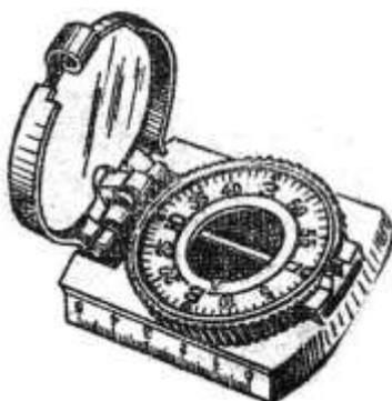
На внутренней стороне предохранительной откидной крышки компаса АК прикреплено металлическое зеркало, которое при визировании устанавливается так, чтобы в нем были видны магнитная стрелка и лимб. Это позволяет одновременно с визированием на предмет проверить ориентировку компаса и произвести отсчеты по шкале лимба.
